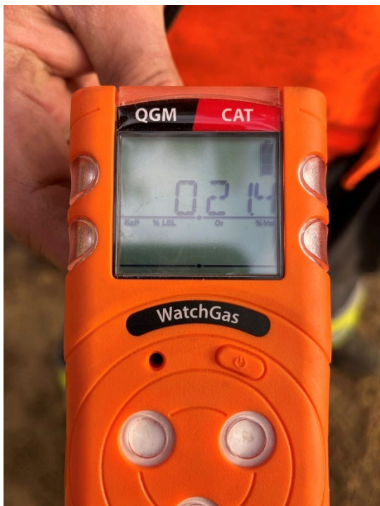
WatchGas QGM Multi Gas Detector met een O 2 -percentage op de display van 21,4%.
