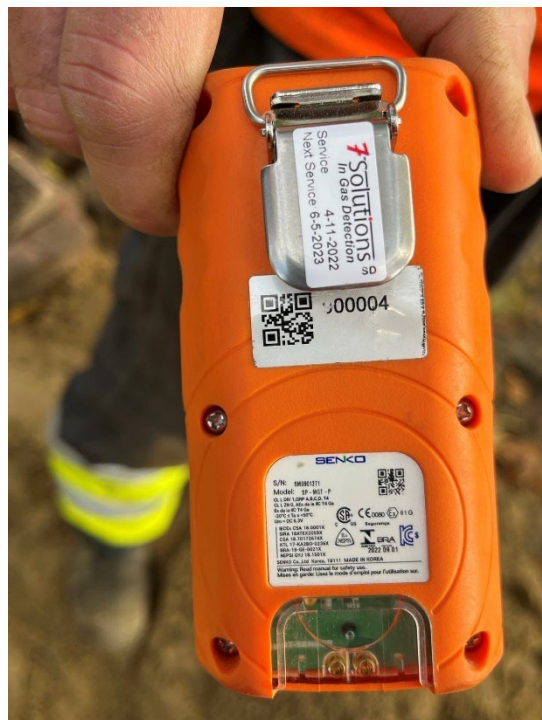
Achterkant van dezelfde gasdetector: inspectie interval van 1x 6 maanden.
