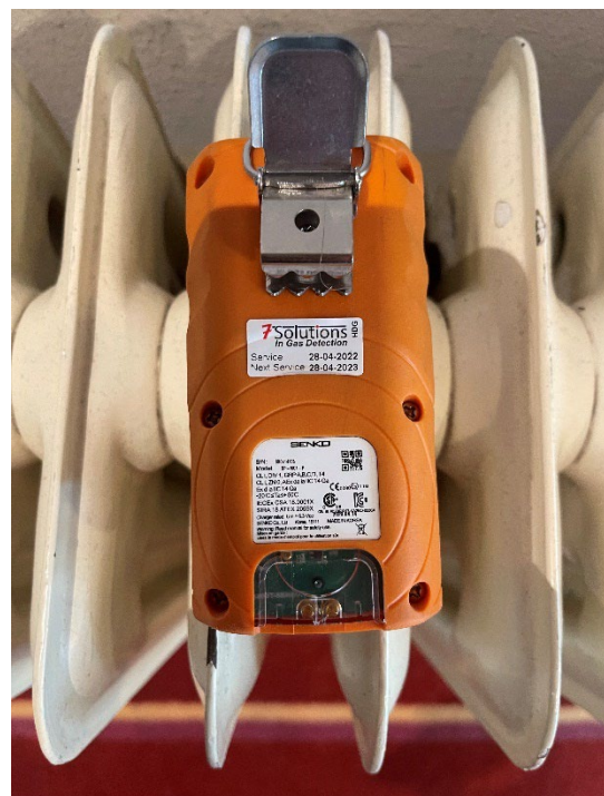
Achterkant van dezelfde gasdetector: inspectie interval van 1x jaar.
