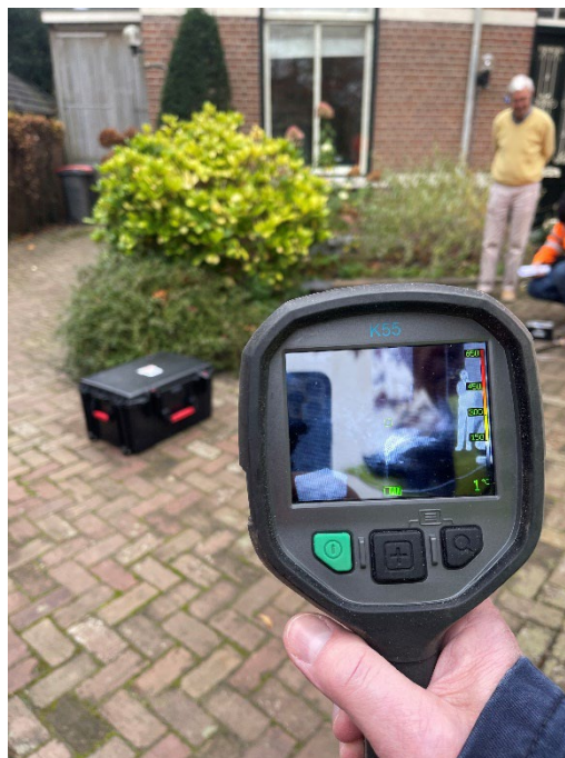
Met warm tebeeldcamera wordt de brandende waterstofvlam zichtbaar gemaakt.
