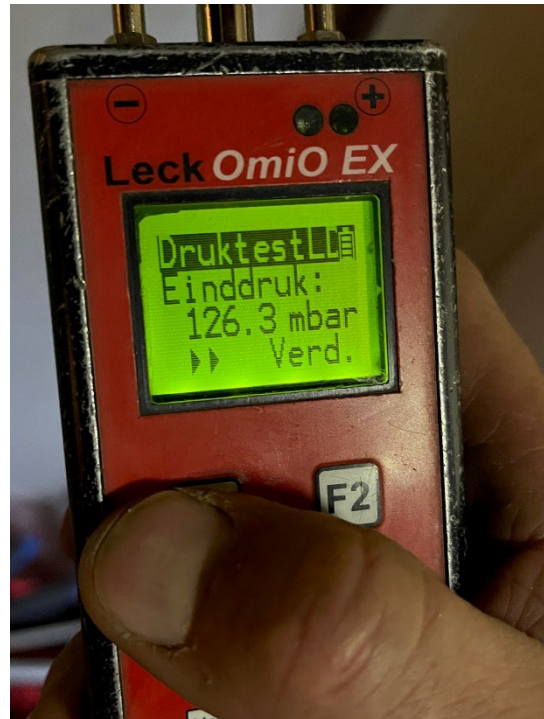
Einddruk dichtheidsbeproeving gasmeteropstelling.
