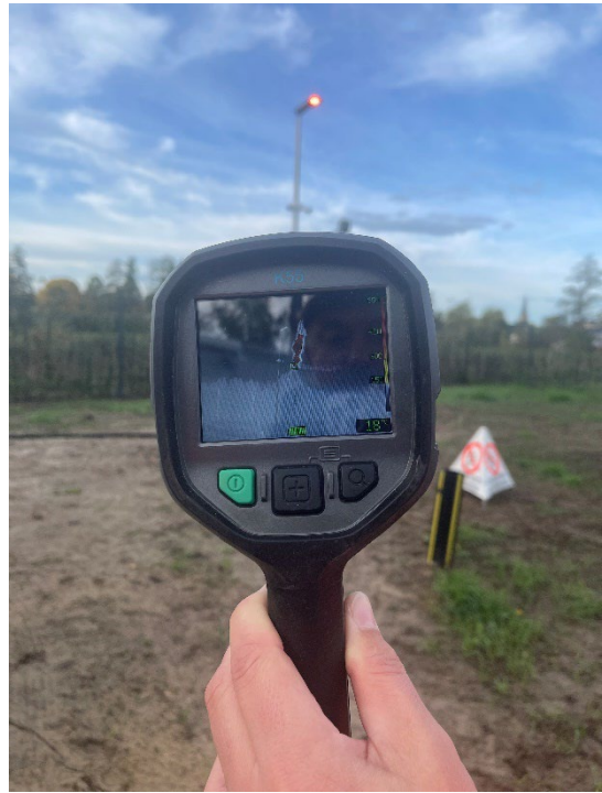
H 2 -vlam zichtbaar gemaakt met behulp van een warmtebeeldcamera.
