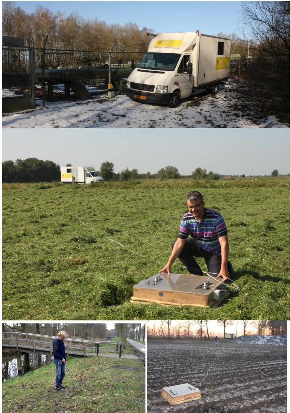
Figuur 2: De drie verschillende meetmethoden: mobiel (boven), met een slang (linksonder) of de kamermeting (midden en rechtsonder).
