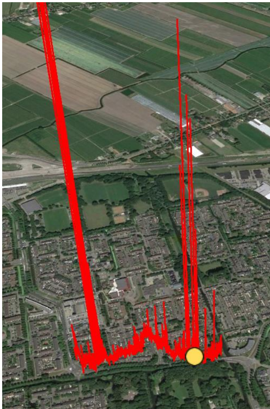
Figuur 37: Slangmeting over het tracé van het persriool: hoge emissie op de putpositie. Links zeer hoge emissie op lekkende afsluiters van het persriool. De basislijn laat bij dit voorbeeld een brede piek zien. Dat is een methaanbron vederop. (andere metingen laten dit niet zien).
