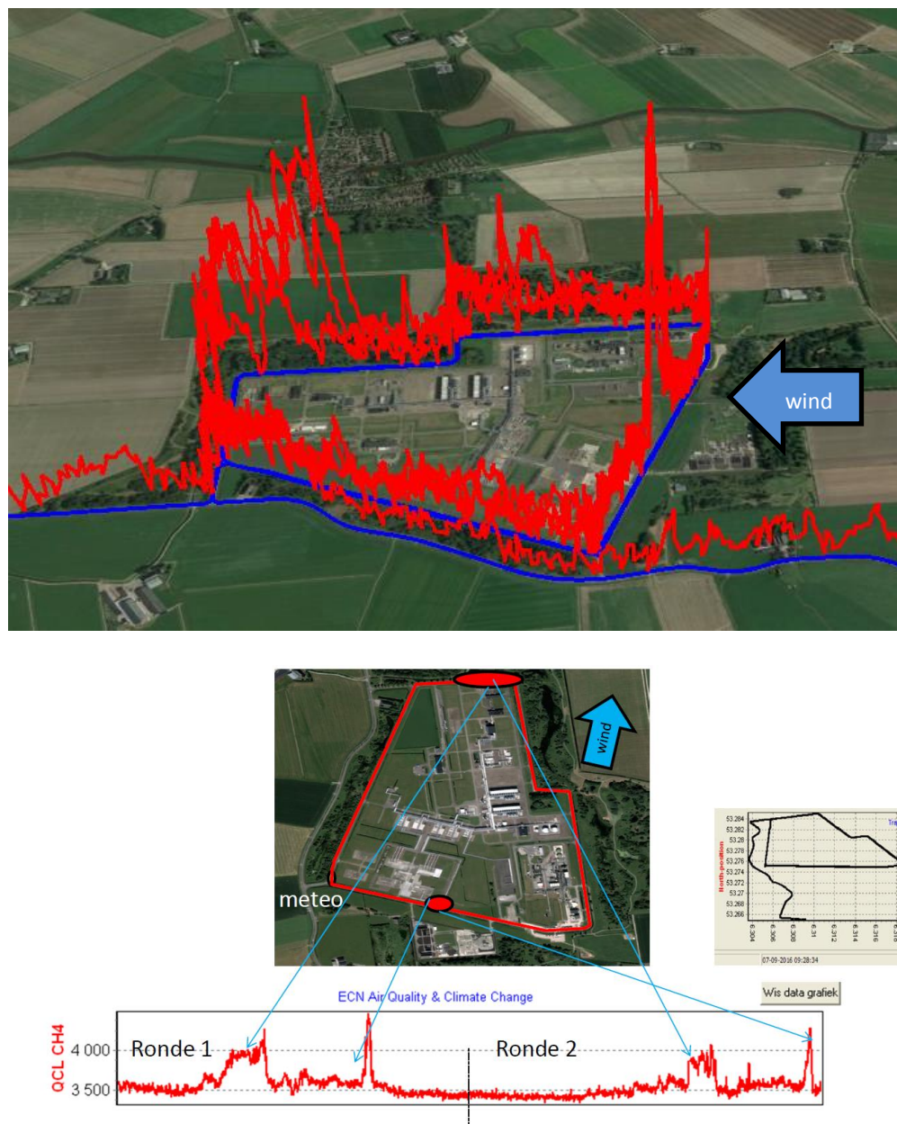
Figuur 15: Pluimmeting rondom gasbehandelingslocatie Grijpskerk. Boven: een compilatie van een aantal rondritten om de locatie. Onder: kaart van de locatie met GPS positie plus een tijdlijn van de gemeten concentratieniveaus. De metingen zijn in ppb CH 4 .
