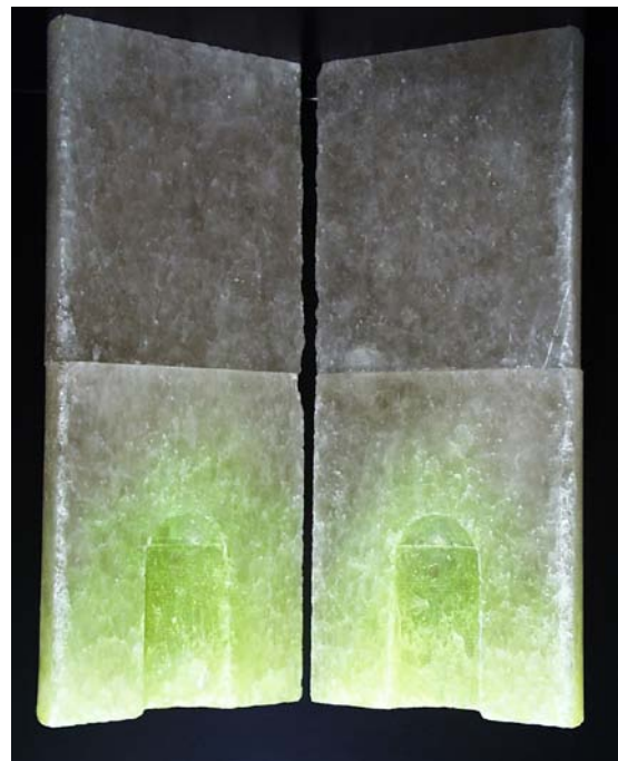
Bild 6.7 Ausbildung der Infiltrationszone in einem Prüfkörper mit einem kavernendachartigen Injektionsraum
