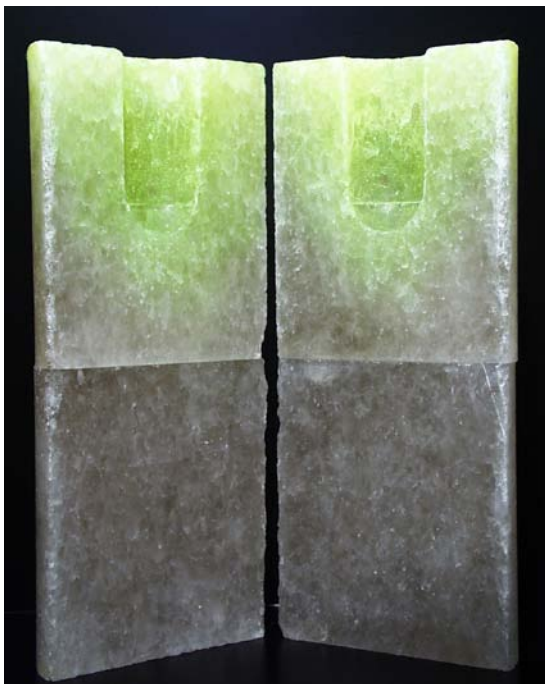
Bild 6.7 Ausbildung der Infiltrationszone in einem Prüfkörper mit einem kavernendachartigen Injektionsraum
