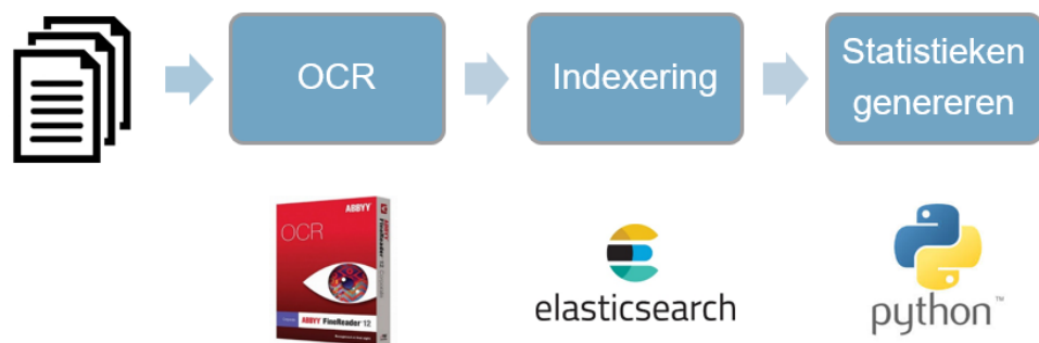
Figuur 3.1 Stroomschema voor de geautomatiseerde documentanalyse, waarbij gescande documenten middels optical character recognition (OCR) en een indexering middels elasticsearch doorzoekbaar worden gemaakt, met gebruikmaking van scripts in python .
