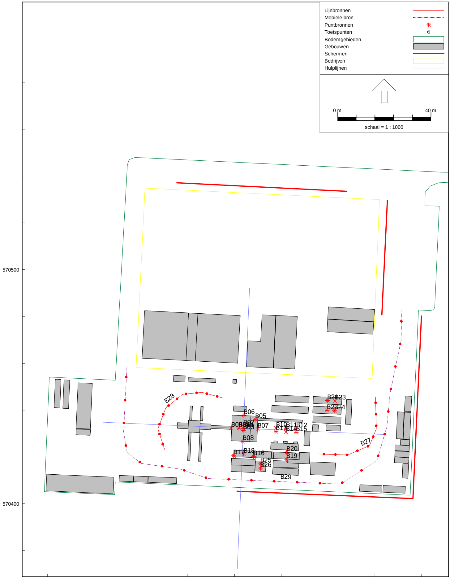
Detail van het rekenmodel van WHC-1 met de ligging van de ingevoerde geluidsbronnen
