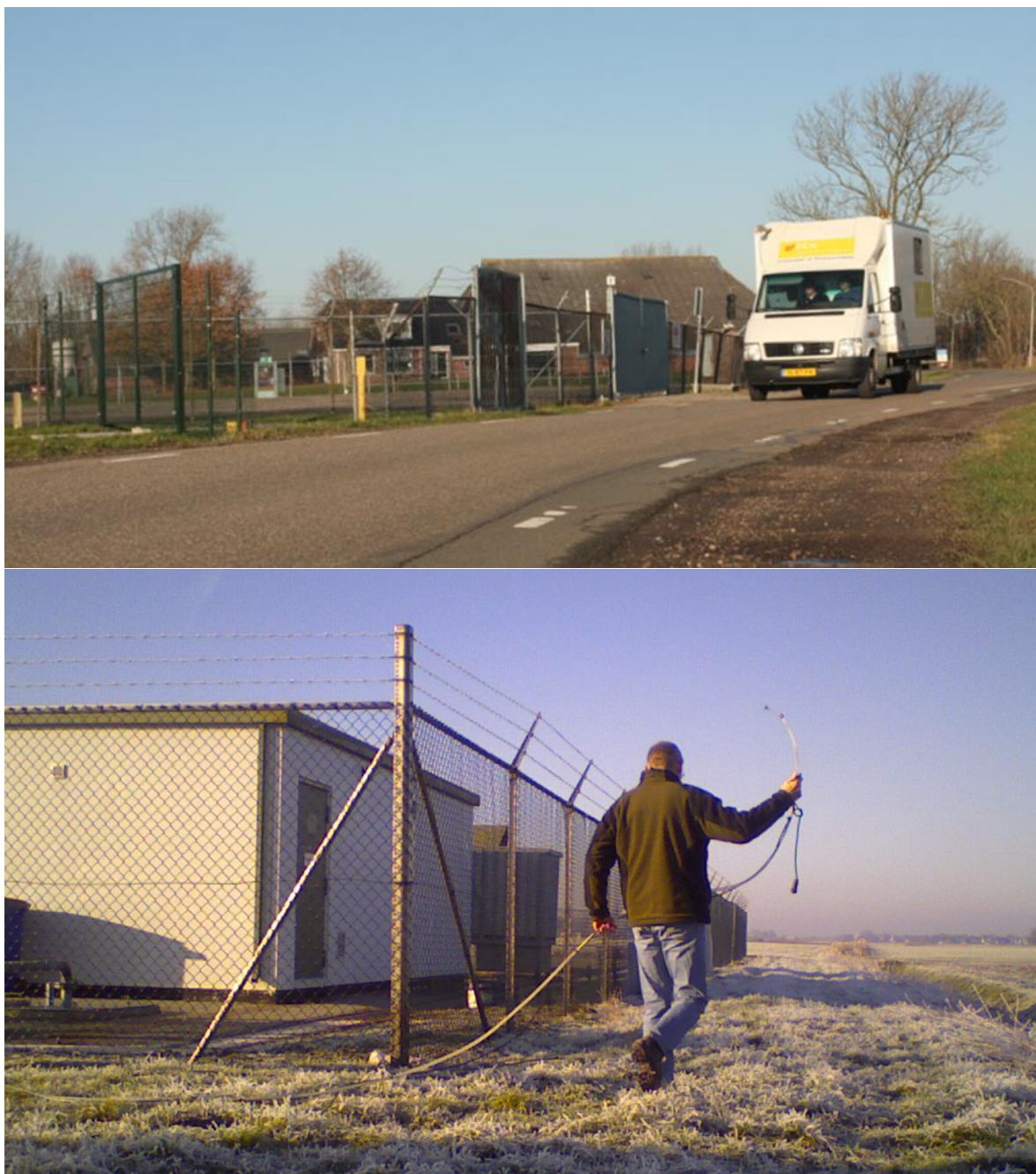
Figuur 2: De twee verschillende meetmethoden: mobiel (boven) en stationair met een slang (onder).
