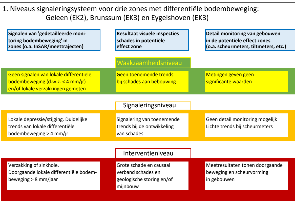
Figuur 15 Signaleringssysteem voor de drie zones met differentiële bodembeweging door mijnwaterstijging met drie niveaus. Signaleringsparameters zijn bodembeweging (mm/jaar) en het ontstaan en toename van schade aan gebouwen.
