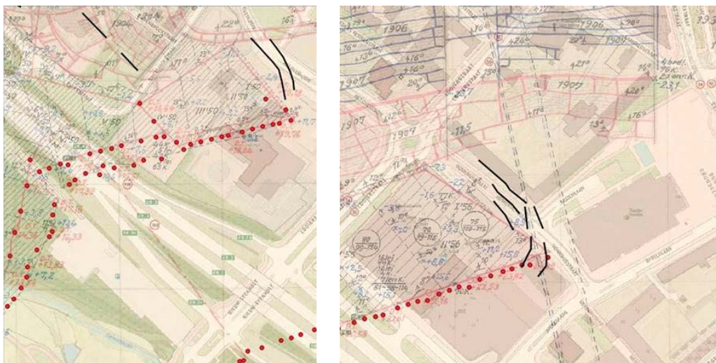
Figuur 32 Mijnbouwkundige situatie van de hoekpunt van Laag IV bij DSM-kantoorgebouw (links) en de hoekpunt van laag V bij de sinkhole van 't Loon (2011) in Heerlen (rechts). De rode punten zijn opwaartse boringen van de galerijen naar bovenliggend dekterrein (waterhoudend kalkgesteente). Zwart zijn de mijnbouwkundige drempels aan het oppervlak.
