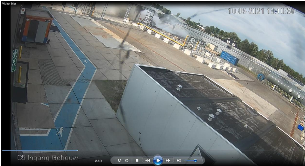
17:10:34 rondvliegende installatie delen en delen van de leiding door het snel uittredende water en methaangas.(Tijdsregistratie Camera systeem 18:10:34)
