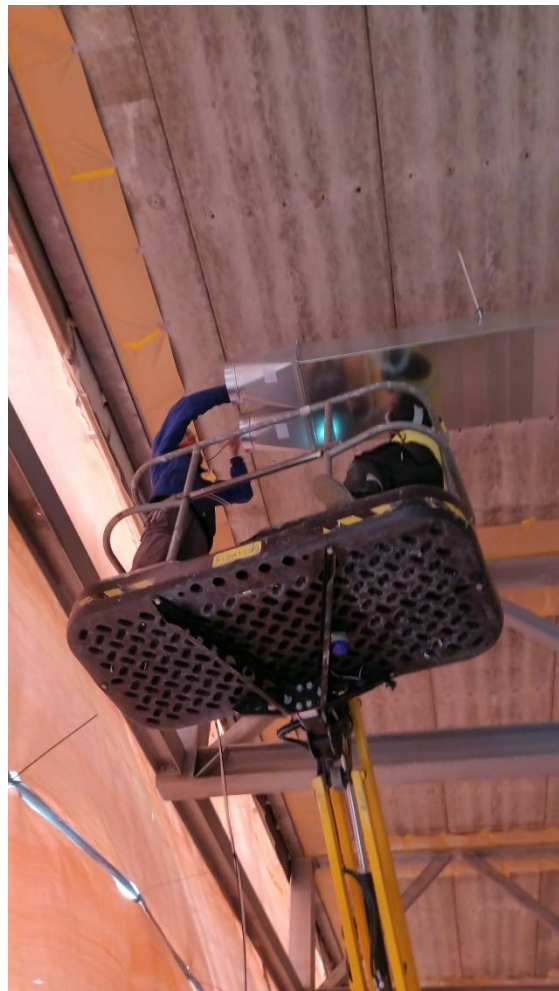
Figuur 52: Aanzuigslang van QCL wordt bij de uitlaat van het ventilatiekanaal gehouden. Daarna worden twee monsterzakken gevuld.
