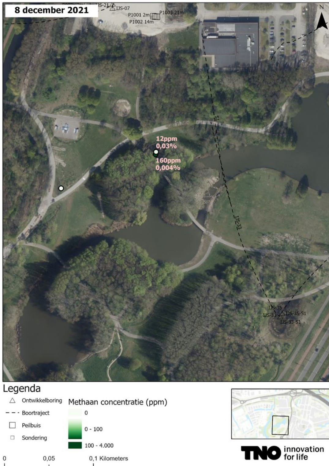
Figuur 32: Methaanconcentratie metingen (ppm) aan bodemonsters uit meetlocatie Park De Twee Heuvels. Op de kaart staan zowel de metingen met gat als zonder geboord gat (in roze letter kleur). De metingen zijn gelabeld. Op deze labels is de ratio ethaan/methaan (%) toegevoegd. . Opmerking: in deze figuur wordt voor de decimalen een komma gebruikt in plaats van een punt.
